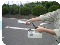
現場でのサーベイメータによる測定
