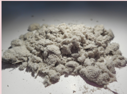
吹付材、保温材
