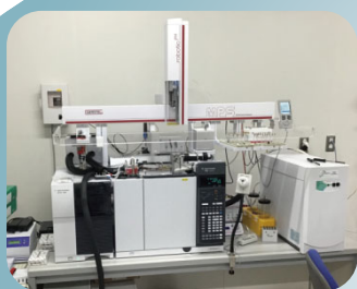
TDU-GC/MS/FPD (におい嗅ぎGC/MSシステム)
